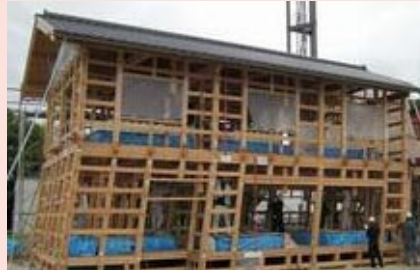
基準法で定める層間変位角層間変位角より傾いてはいるが、倒壊しない。
